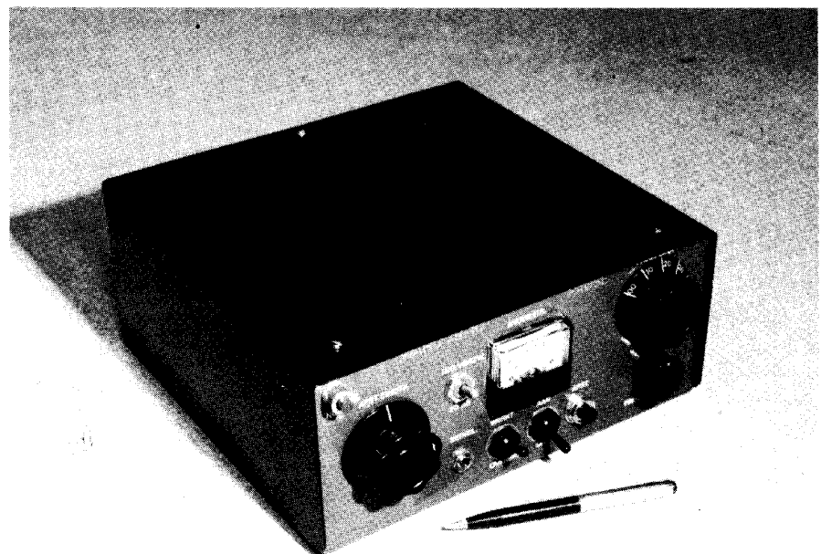
Foto 1. WARC 79-10 is ondergebracht in een kastje van 26 cm breed, 11,5 cm hoog en 25 cm diep. (Foto's van de schrijver).
