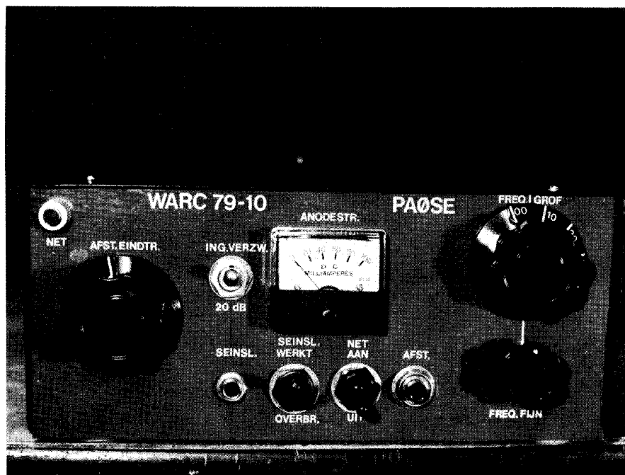
Foto 2. Het instellen van de zendfrequentie gebeurt met twee knoppen voor grof- en fijninstelling. Zo is een dure en moeilijk te krijgen knop met vertraging vermeden.
